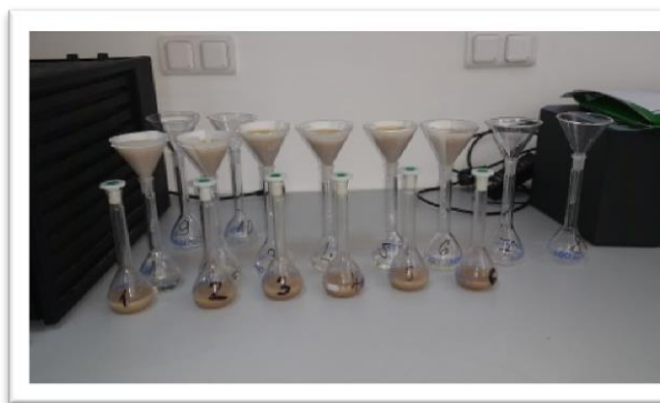
Slika 20. Uzorak pripremljen za očitavanje škroba (Izvor: vlastita fotografija)
