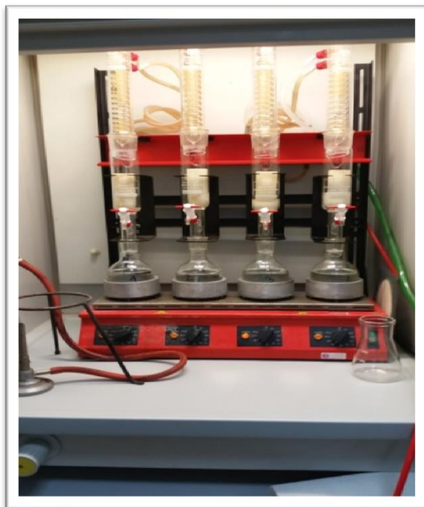
Slika 19. Soxhlet ekstraktor za određivanje masti (Izvor: vlastita fotografija)
