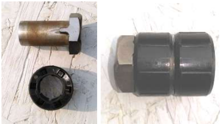
Slika 59. Sastavljanje matice i plastičnih prstena/držača
