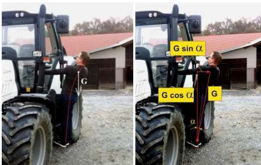
Slika 21. Prikaz položaja operatera kod ulaska bez sustava daljinskog upravljanja
