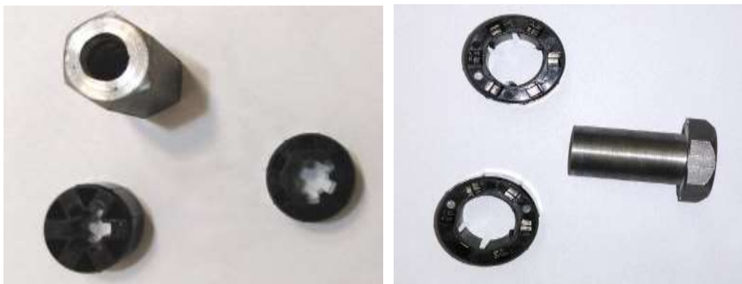
Slika 57. Navojna matica i plastični prsteni
