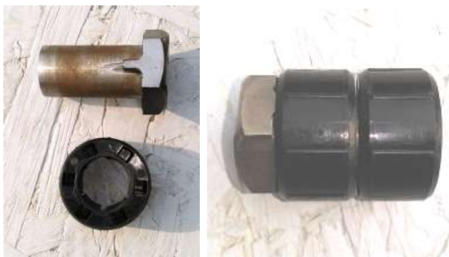
Slika 59. Sastavljanje matice i plastičnih prstena/držača
