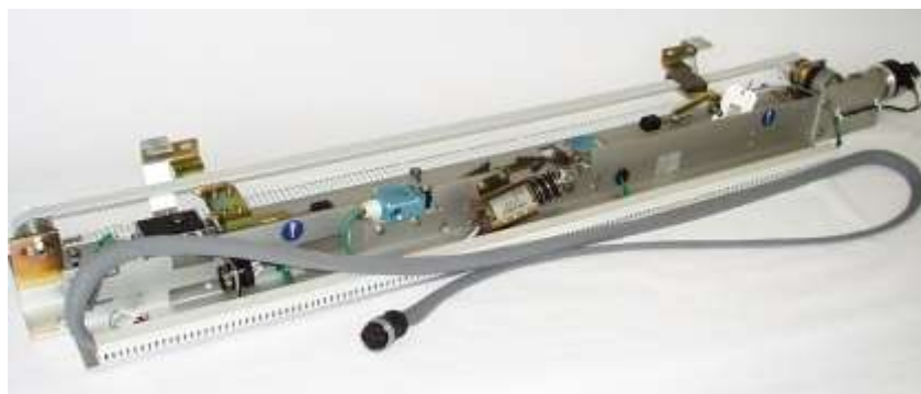
Slika 6. Uređaj za upravljanje vratima pomoću elektromotora (www.ife-tebel.nl)
