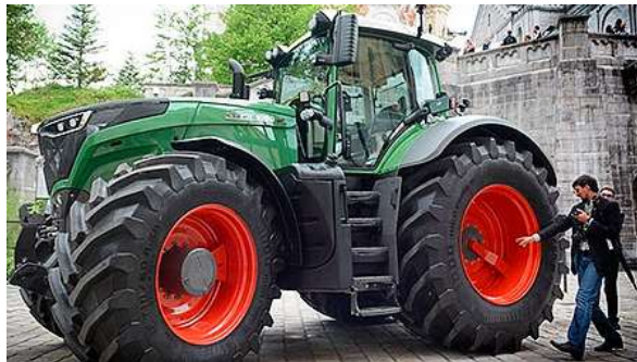
Slika 23. Prikaz glavnih ulaznih (lijevih) stuba kod traktora Fendt 1050 (www.fendt.com)
