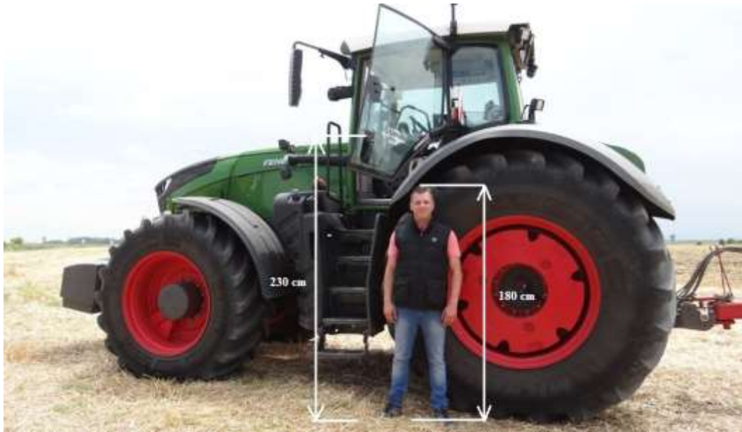
Slika 27. Omjer visine brave vrata na osobu visine 180 cm
