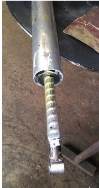
Slika 60. Navojna matica s navojnom šipkom u cijevi elektromotora
