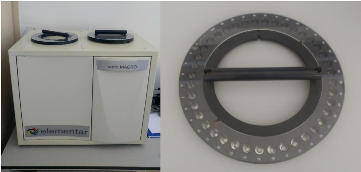
Slika 12 : CHNS analizator s autosamplernom (Izvor : vlastita arhiva)
