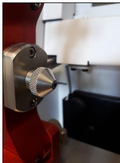
Slika 12. Safirni kristal za formiranje tankog sloja uzorka propolisa
