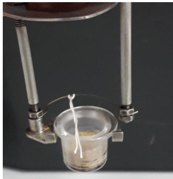
Slika 19. Uzorak za kalorimetriju
