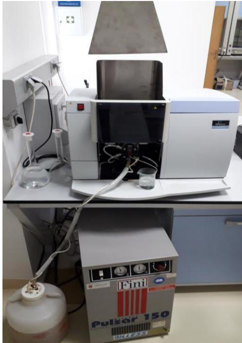
Slika 20. Atomski apsorpcijski spektrometar
