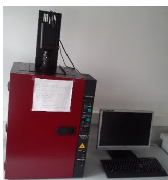
Slika 13. UV transiluminator i uređaj za snimanje gela UVItech explorer Version 15.01.c (UVItec Ltd., Cambridge, UK) (Brajković, 2018).
