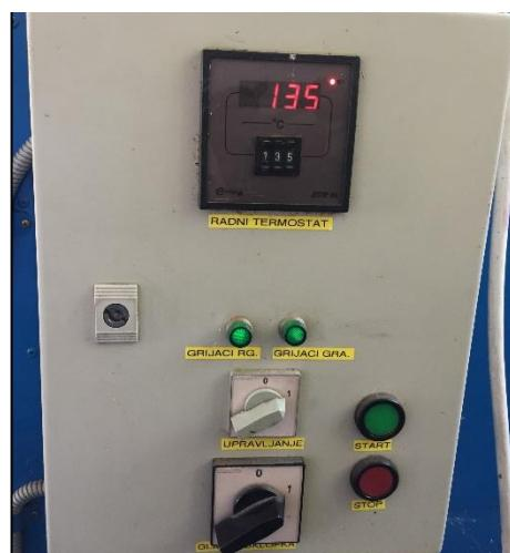
Slika 12. Radni termostat (Izvor: Vlastiti)
