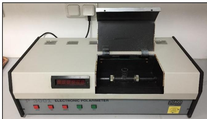
Slika 16. Polimetar za određivanje škroba (Izvor: Vlastiti)
