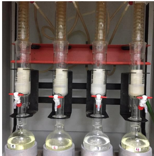
Slika 15. Aparat za ekstrakciju masti po Soxhletu (Izvor: Vlastiti)
