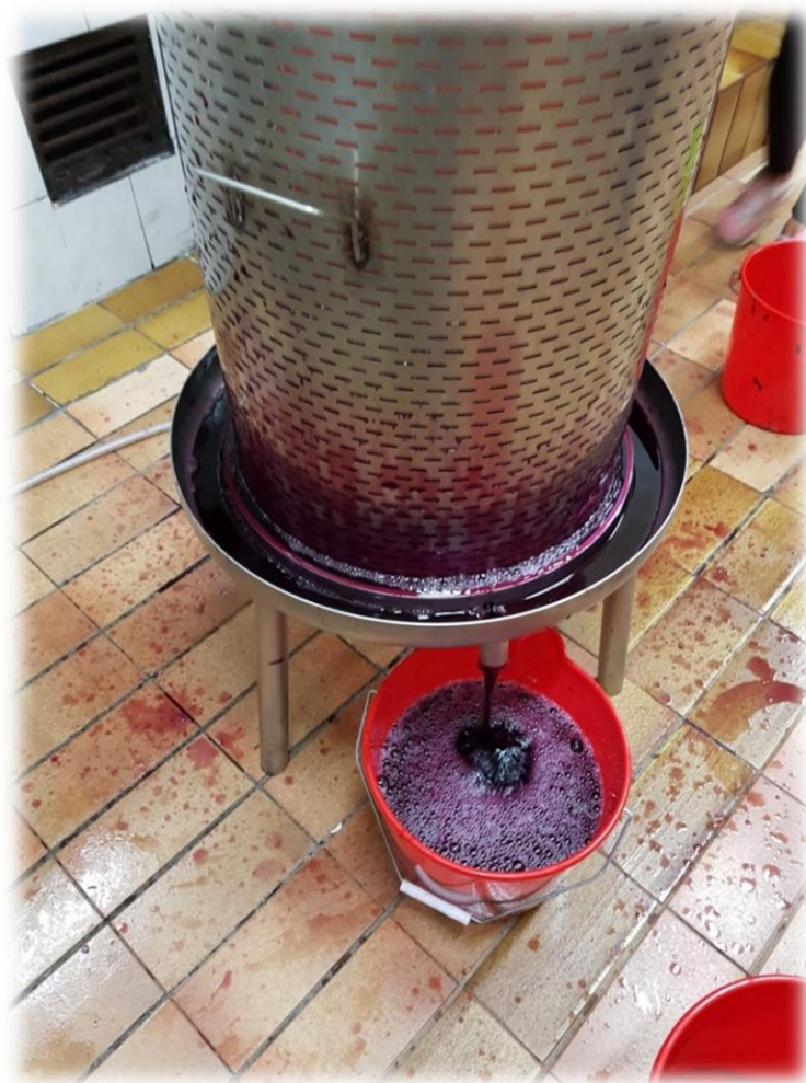
Slika 12. Prešanje masulja vodenom prešom
