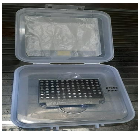
Slika 4.4.2. MALDI pločica sa nanesenim uzorcima, mravljom kiselinom i MALDI matricom
