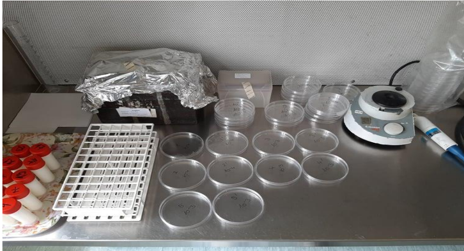
Slika 4.3.2. Radna površina s potrebnim priborom za određivanja ukupnog broja aerobno mezofilnih bakterija u mlijeku klasičnom metodom HRN EN ISO 4833-1:2013
