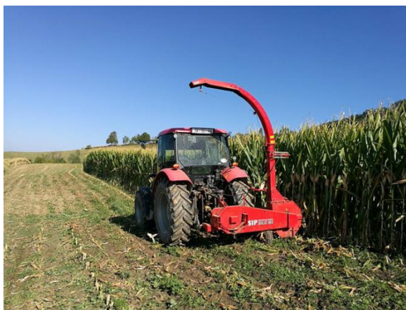
Slika 2. Košnja i usitnjavanje biljne mase – silo-kombajn
