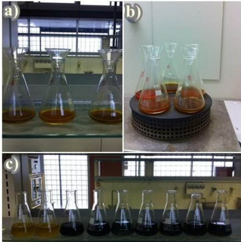
Slika 4. – Određivanje količine humusa. a) priprema uzoraka; b) kuhanje uzoraka ; c) uzorci prije i nakon titracije
