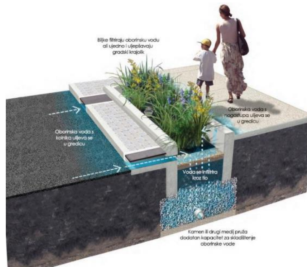
Slika 3.3.5. Presjek kišnog vrta.
