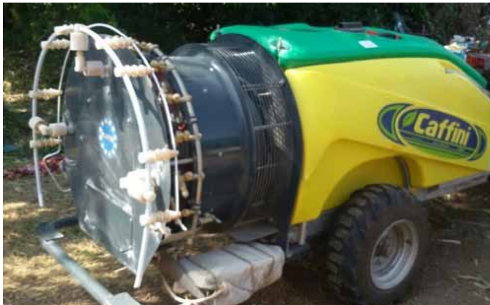
Slika 7. Tathastu elektrostatički sistem postavljen na konvencionalnu sustav (Izvor: tathastuservices.com)
