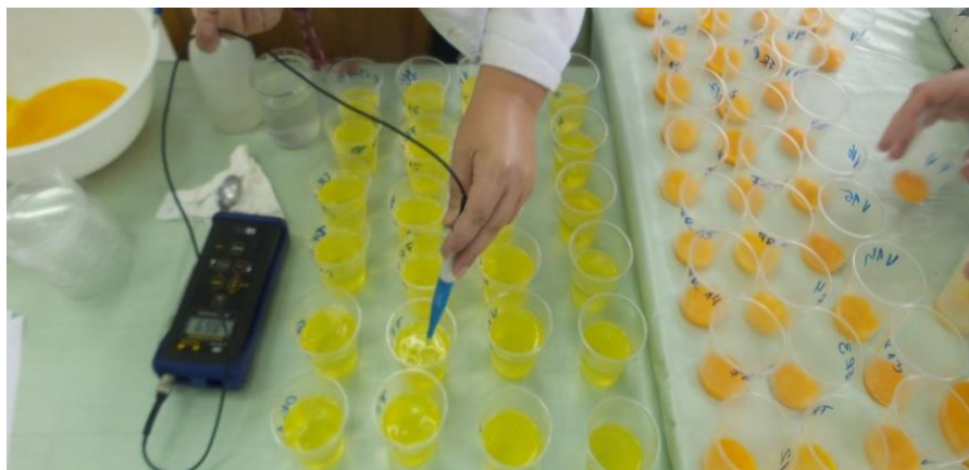
Slika 28. Mjerenje pH vrijednosti (Izvor: I. Ivanković)
