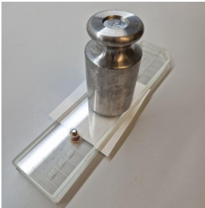
Slika 21. Mjerenje sposobnosti vezanja vode (Sp.v.v) (Izvor: Z. Kralik)
