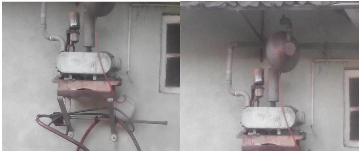
Slika 13. Podtlaćna pumpa i filter zraka (Foto: Švub)
