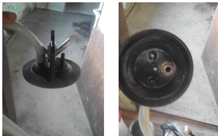
Slika 5. Pulzator – srce muznog uređaja (Foto: Švub)
