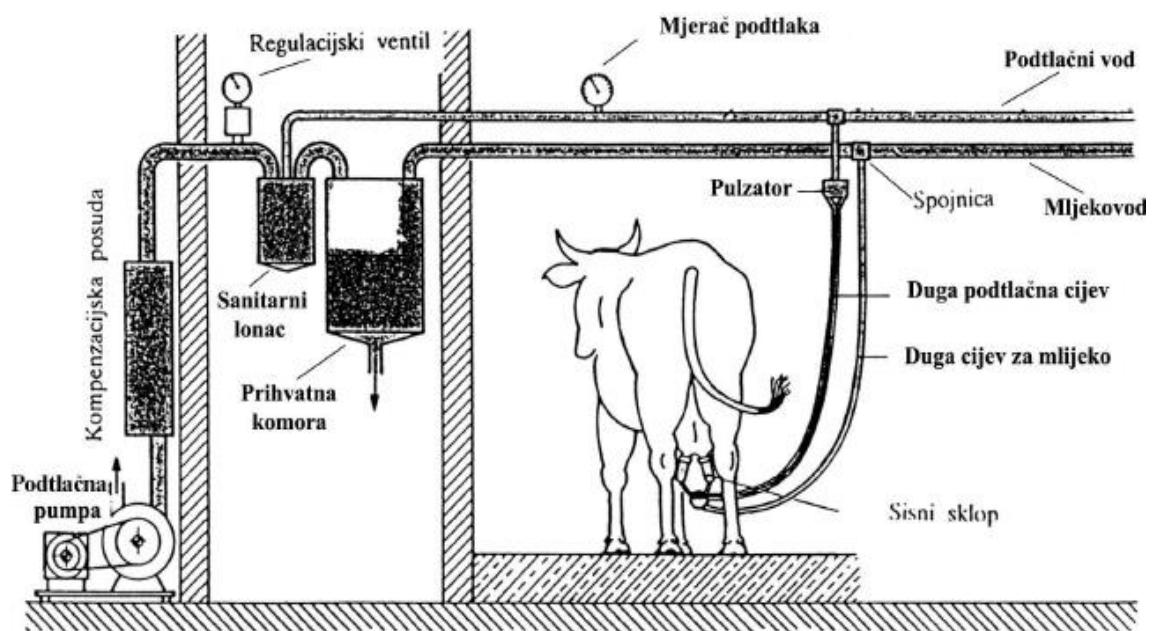
*Slika 11. Dijelovi uređaja za mužnju u mljekovod*
