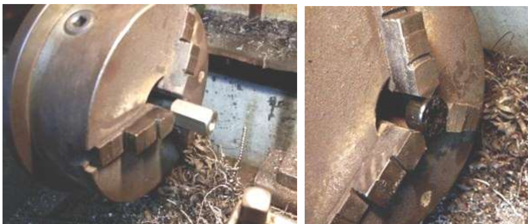
Slika 58. Tokarenje matice i plastičnih prstenova
