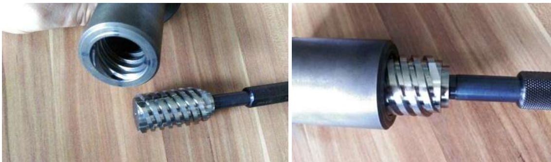
Slika 67. Kontrolni trn (kalibar) za trapezni navoj koraka 28 mm
