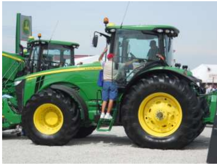
Slika 20. Prikaz konstrukcije kabine s velikim staklenim površinama
