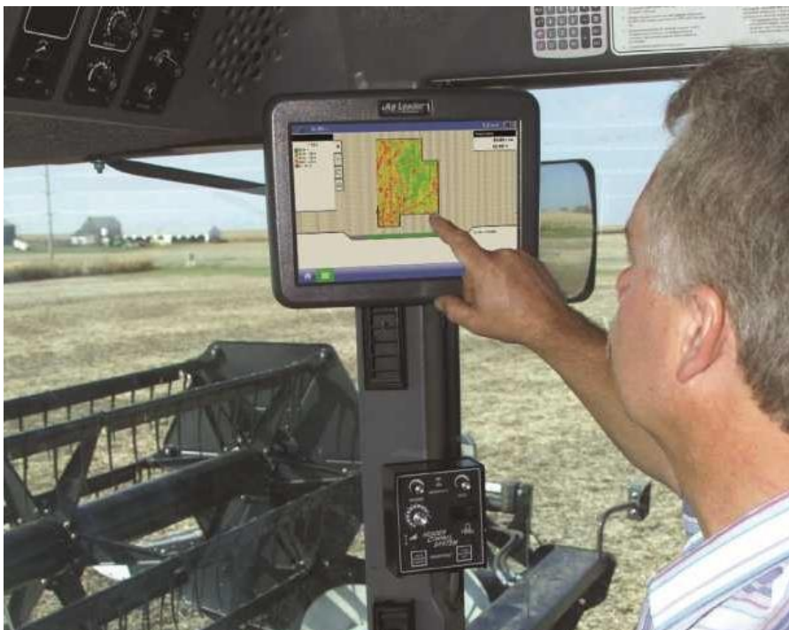
Slika 6.12.. Korisničko sučelje modernog sustava za mjerenje uroda smješteno u kabini kombajna (sastoji se od sjedinjenog zaslona osjetljivog na dodir i računala) (AgLeader)
