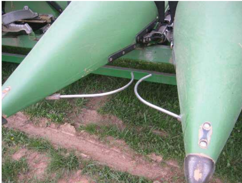
Slika 6.11. Ticala senzora za navođenje žetvenog uređaja kombajna u berbi kukuruza Izvor: Zimmer i sur., 2009.
