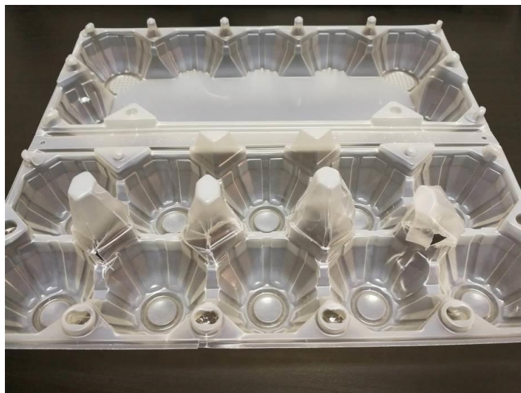
Slika 11.8. Razorena struktura središnjih stožaca polimernih kutija
