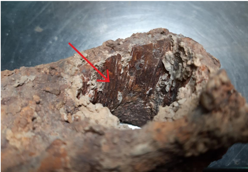
Slika 4. Detalj mineraliziranog drva u glavi motike, snimio: R. Erdelji 2022.
