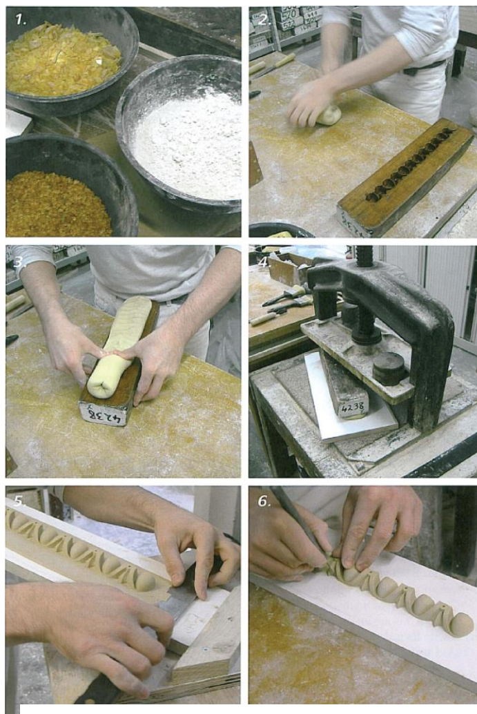
Sl. 129 - Utiskivanje kompozitne mase u drveni kalup
