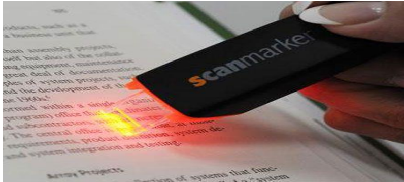
Slika 11. Olovka za čitanje ili scanmarker
