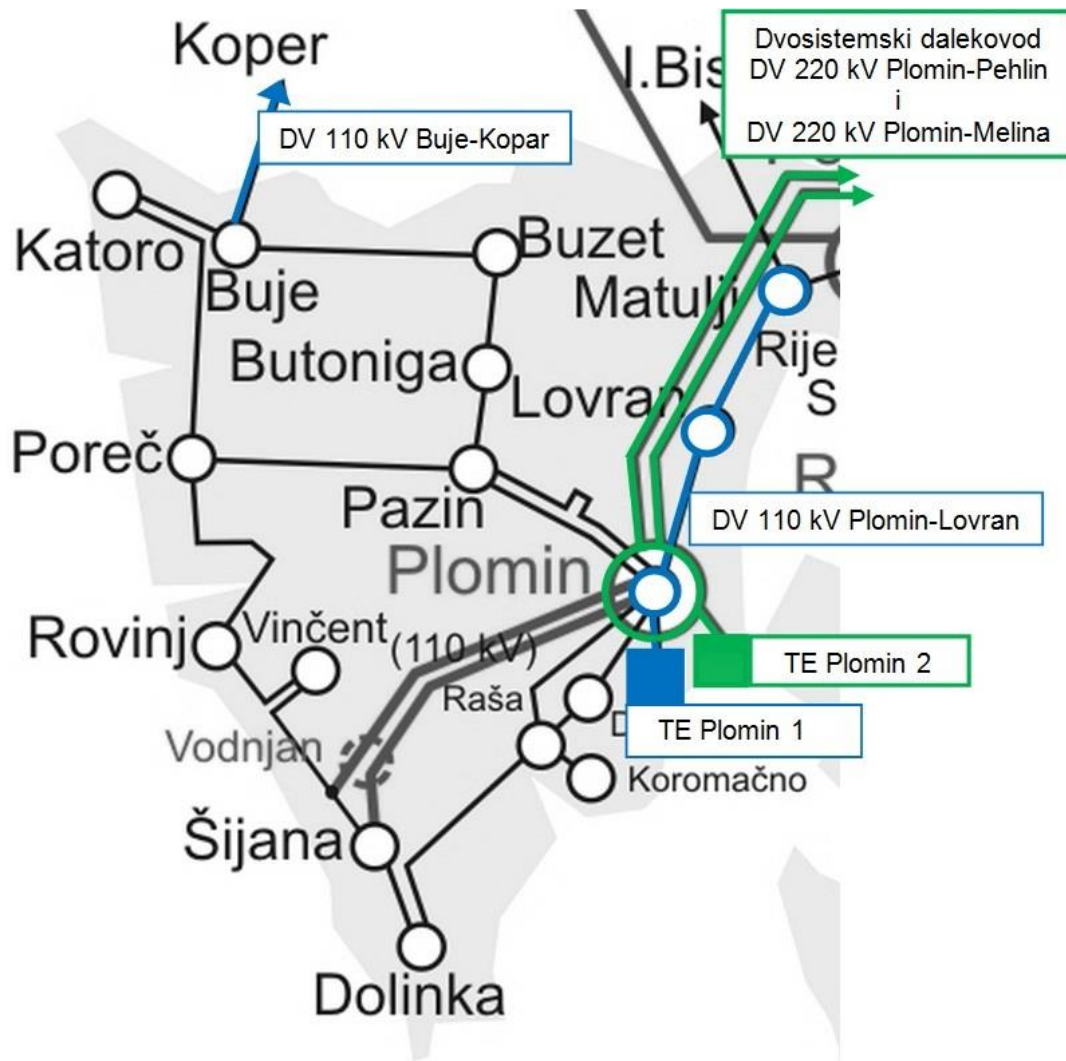
Slika 9.1 Elektroenergetski podsustav Istre
