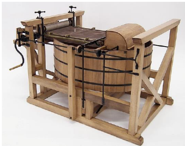
Slika 3 Model prvog stroja za izradu papira [7]
