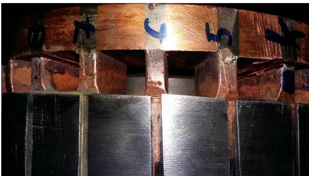
Slika 6.41 Mjesto na kaveznom namotu gdje su prekinuta dva štapa rotora – područje tik uz prsten
