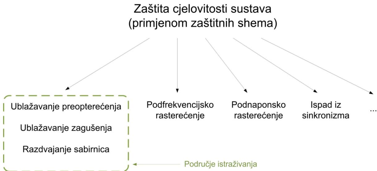
Slika 2.3 Dio funkcija zaštite cjelovitosti sustava
