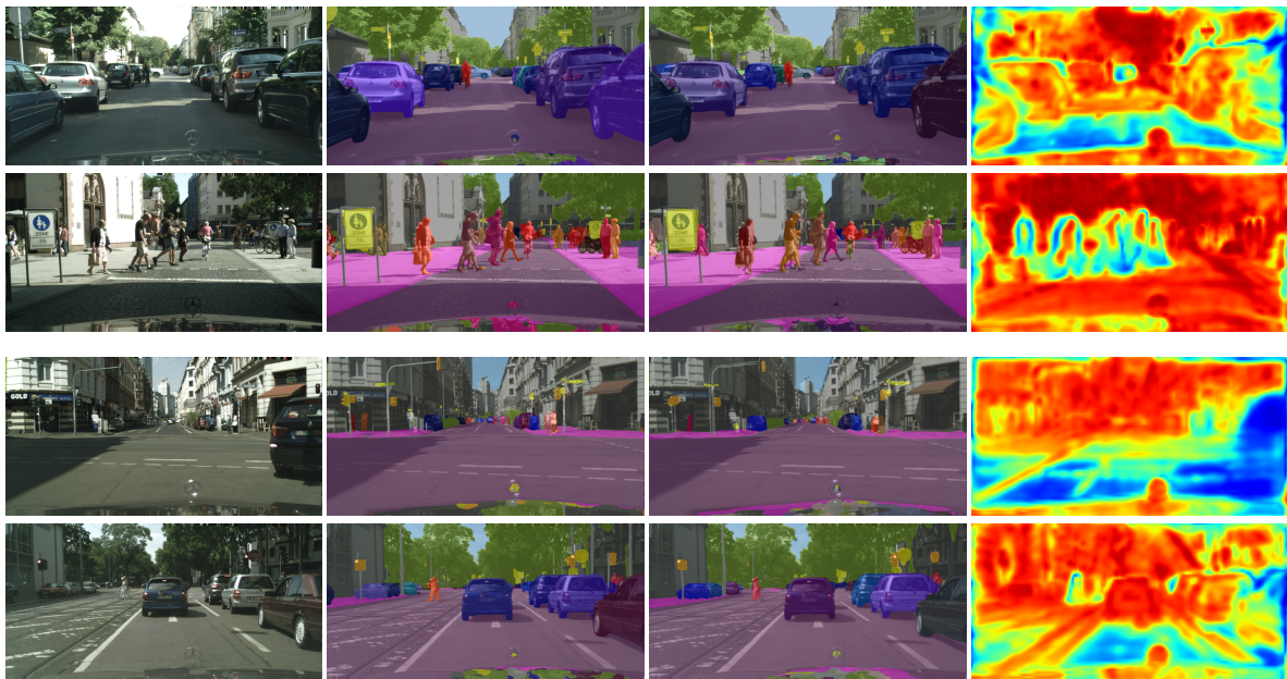
Slika 6.4: Kvalitativni rezultati prognoziranja panoptičke segmentacije na Cityscapesu. Slika prikazuje dva primjera kratkoročnog prognoziranja (gore) i dva primjera srednjoročnog prognoziranja (dolje). Stupci prikazuju posljednji opaženi slikovni okvir, predikcije modela proroka u budućem okviru, našu prognozu te toplinsku mapu faktora miješanja \beta^{F2M} . Samo pri vizualizaciji, budući slikovni okviri iscrtani su ispod semantičkih predikcija kako bi se lakše pratila točnost naše prognoze.
