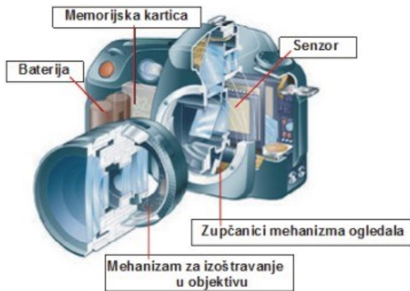
Slika 5. Dijelovi digitalnog fotoaparata (Izvor: https://unze.ba/am/pzi/2009/PopovicDarko/digitalni_aparat.html )
