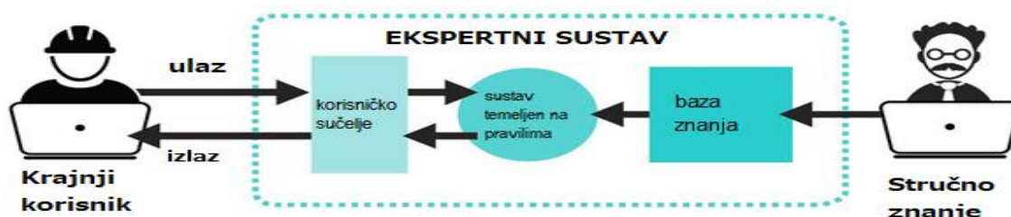
Slika 2.1.2: Shema osnovnih dijelova ekspertnog sustava 6
