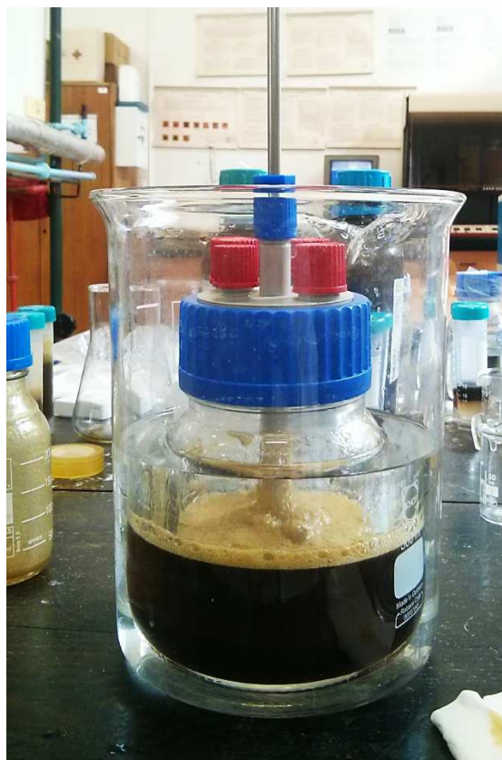
Slika 16. Zagrijavanje otpadne životinjske masti pomoću vodene kupelji
