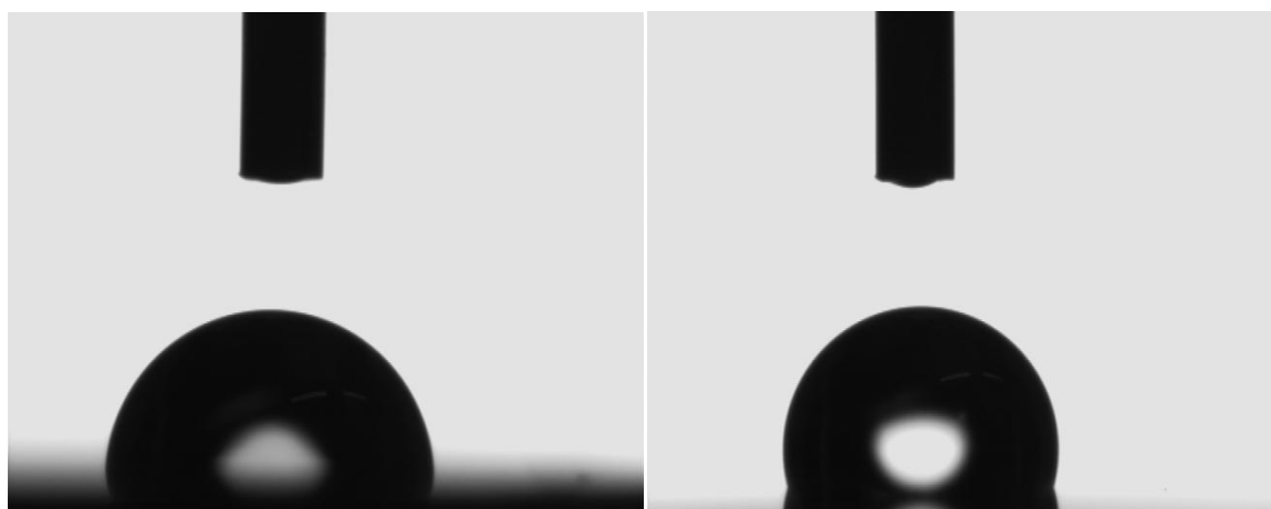
Slika 28. Prikaz kontaktnog kuta na netretiranom (čista površina bakra) i tretiranom uzorku.
