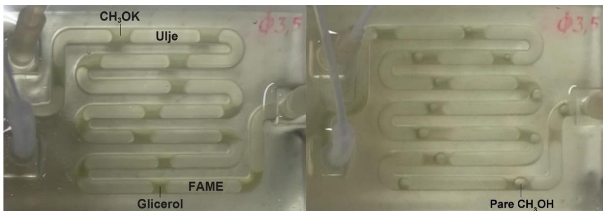
Slika 60. a) Fotografija milireaktora u uljnoj kupelji tijekom sinteze T = 50\text{ °C} , \varphi = 3,5\text{ mm} (prva šprica ulje suncokreta, druga šprica metanol+KOH). b) Fotografija milireaktora u uljnoj kupelji tijekom sinteze T = 60\text{ °C} , \varphi = 3,5\text{ mm} .
