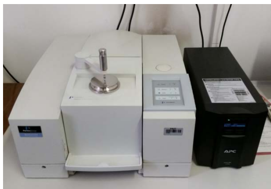
Slika 12. FTIR spektrometar, PerkinElmer Spectrum One Spectrometer s ATR komorom
