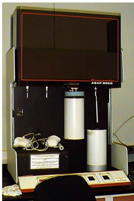
Slika 14. Uređaj za određivanje veličina pora, ASAP 2000 ( Micromeritics, SAD )
