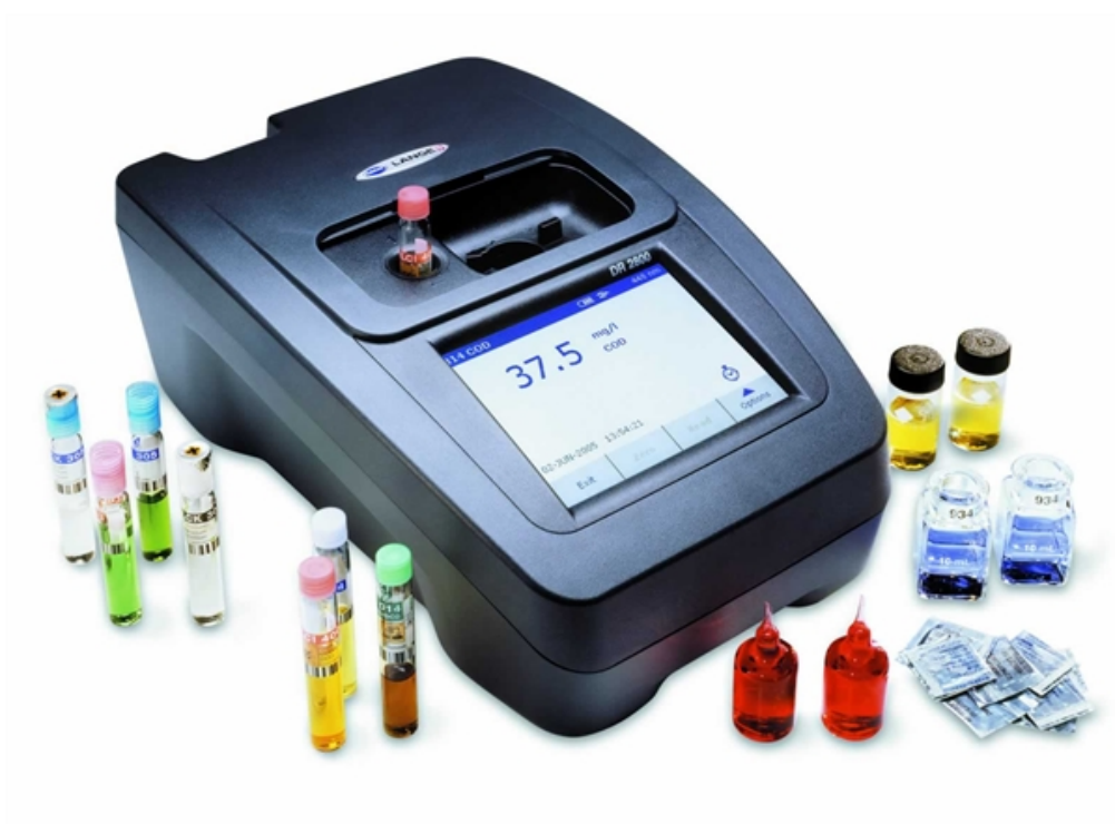
Slika 10. DRB2800 spektrofotometar, Hach
