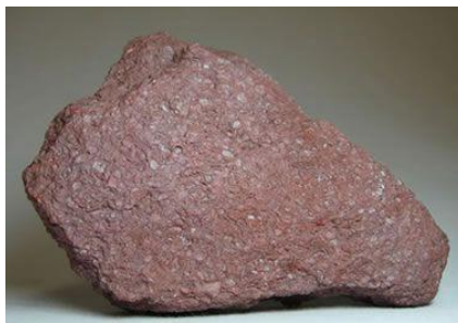
Slika 2.2. Hematit, \alpha - \text{Fe}_2\text{O}_3 . [9]
