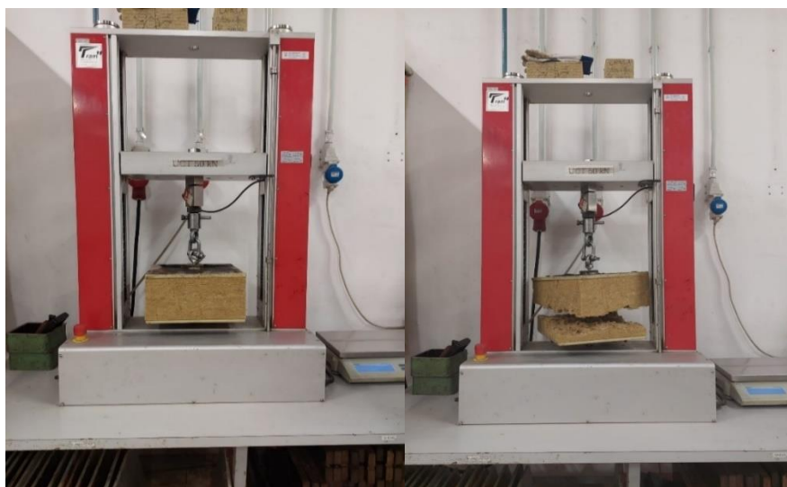
Slika 22. Uređaj Bent Tram, mjerenje delaminacijske čvrstoće.
