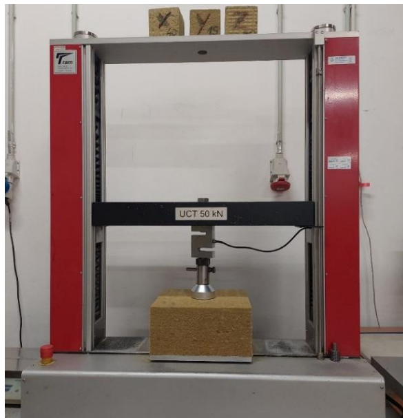
Slika 17. Uređaj Bent Tram, mjerenje točkastog opterećenja.
