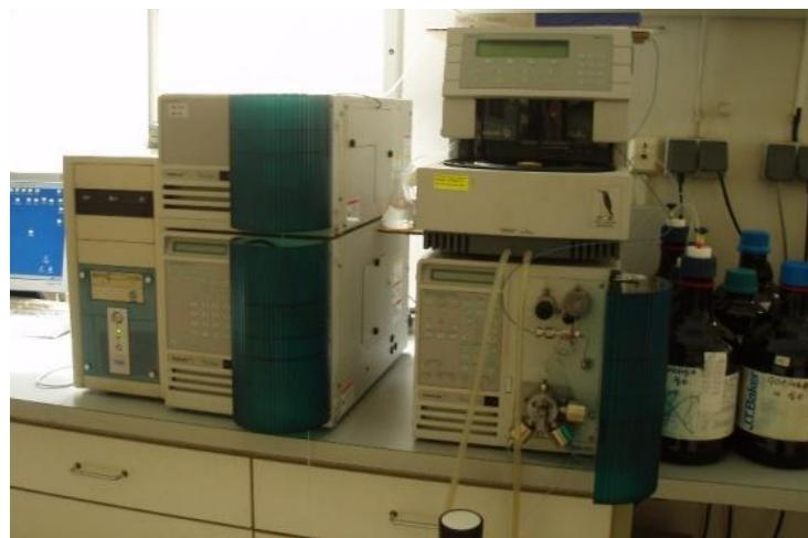
Slika 22. Tekućinski kromatograf visoke djelotvornosti ProStar
