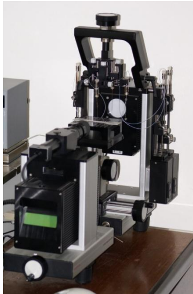
Slika 38. Goniometar, uređaj za mjerenje kontaktnog kuta opremljen video kamerom, softverom za analizu kontaktnog kuta i određivanje slobodne energije površine preko različitih modela
