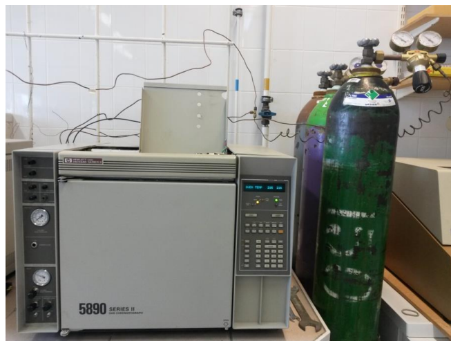
Slika 3.3. Plinski kromatograf (Hewlett 5890)
