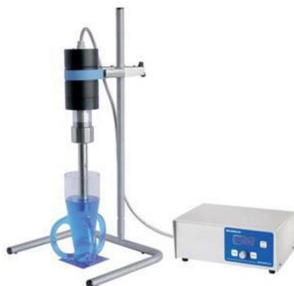
**Slika 3.2.1.** Ultrazvučna sonda Sonoplus HD 34000
