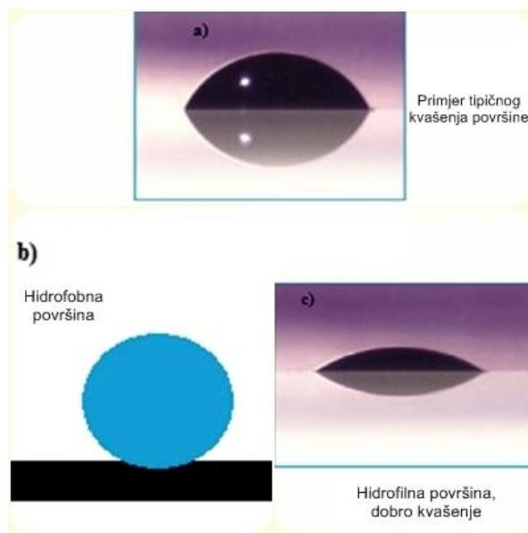
Slika 3. Vrste kvašenja površine a) primjer tipičnog kvašenja površine b) slabo kvašenje, kontaktni kut veći od  $90^\circ$  c) hidrofilne površine, dobro kvašenje [2]
