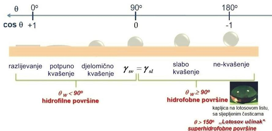
Slika 1. Karakterizacija površine prema iznosu kontaktnog kuta  $\theta$  [3]
