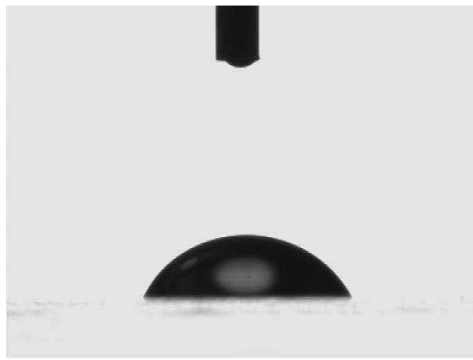
Slika 26. Kontaktni kut vode na površini čistog stakla ( $\theta=63^\circ$ )
