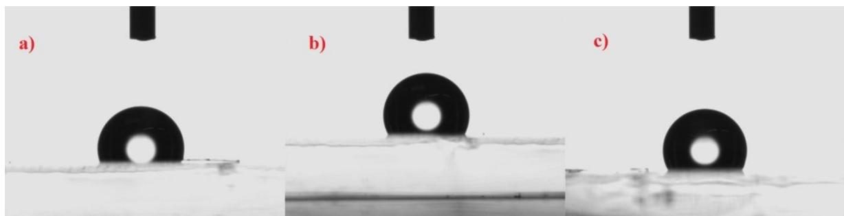
Slika 27. Izmjereni kontaktni kutovi vode na površini stakla obrađenog silanom SIVO 121: a)
