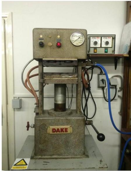
Slika 24. Hidraulička preša DAKE
