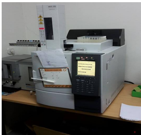
Slika 33. Uređaj za GC analizu- Shimadzu GC-2014
