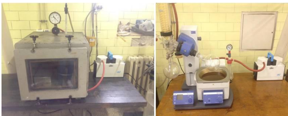
Slika 19. Vakuum sušionik i vakuum isparivač
