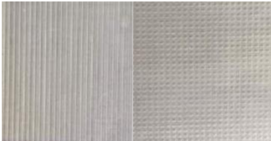
Slika 24. Fotografije strukture elektroispredenih vlaknastih nosača (a) na rotirajućem cilindru (b) paralelni kanalići i (c) kvadratne udubine
