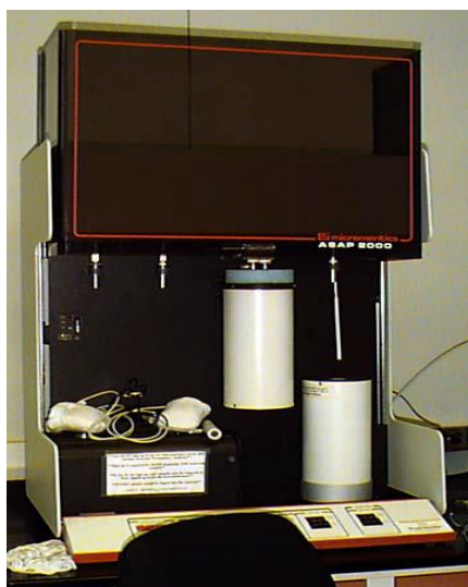
Slika 13. Uređaj za određivanje veličina pora, ASAP 2000 ( Micromeritics, SAD )
