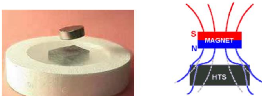
Slika 1.8. Prikaz levitiranja magneta iznad supravodiča
