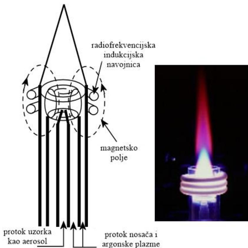
Slika 2. Induktivno spregnuti plazma izvor<sup>[46]</sup>
