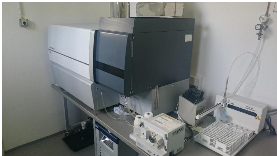
**Slika 9.** ICP-OES za analizu elemenata u tragovima, desno: Auto sampler ASX-260, CETAC
