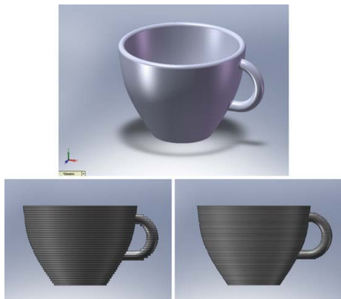
Slika 3. CAD prikaz objekta i utjecaj različite debljine sloja na proces 3D-tiskanja [6]
