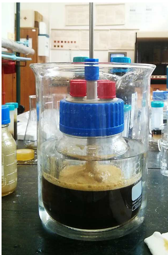
Slika 16. Zagrijavanje otpadne životinjske masti pomoću vodene kupelji
