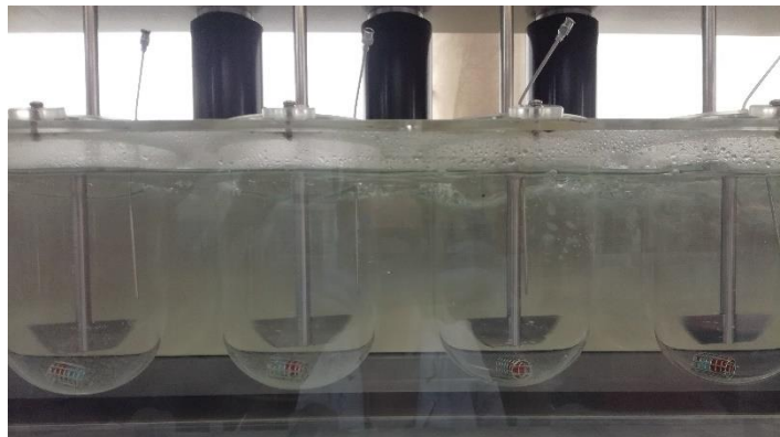
Slika 24. Postupak ispitivanja oslobađanja djelatne tvari
